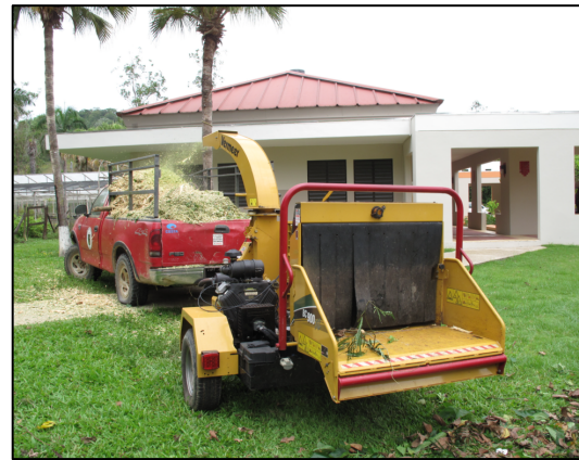
Imagen 10. Trituradora industrial de arboles, permite procesar grandes cantidades de material y transformarlos en viruta.
