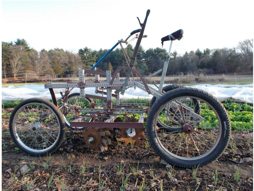
*El Culticycle, un tractor a pedales de para cultivo y siembra, construido con partes de tractores, cuatriciclo y piezas de bicicletas fáciles de conseguir. Foto: Farm Hack*
